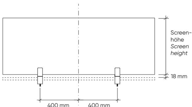
Glasscreen mit Tischklemmen (Klemmbeschlag + Screenadapter) zum Befestigen an Tischen. Beide Screenadapter sind 400 mm von der Mitte aus fest am Screen verklebt. Die Position kann jedoch bei Bedarf vor der Fertigung individuell abgestimmt werden.
