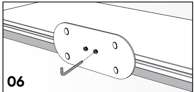
06 Schrauben mit einem Innensechskantschlüssel Grösse 5 gleichmässig fest anziehen.
