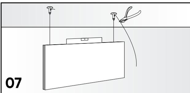
07 Panel mit Wasserwaage ausrichten. Ggf. Seillängen nachjustieren (Schritt 06). Metallseile kürzen.
