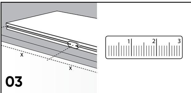
03 Position des vormontierten Paneeladapters für die Befestigung der Fussplatte prüfen. Für CENTERBASE wird die Position in der Mitte des Panels empfohlen.
