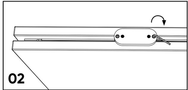
Die Schrauben der Paneeladapter bzw. Anbindungsbeschläge mit einem Innensechskantschlüssel der Größe 3 lösen.
