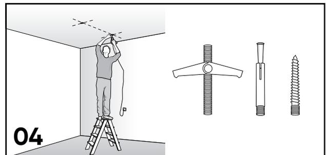
04 Löcher bohren. Für Decke geeignete Dübel mit M6 Gewinde einsetzen.
