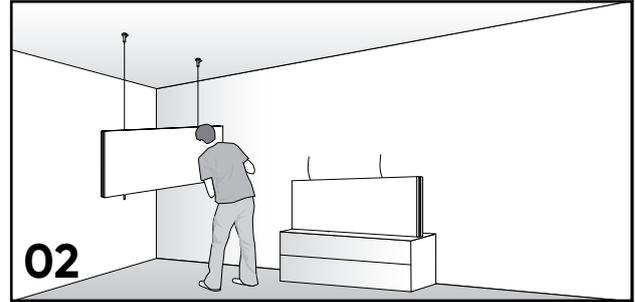
**02** Das obere Panel ist fertig montiert (siehe Montage ACOUSTIC ROOM DIVIDER AIR standard/magnet).
