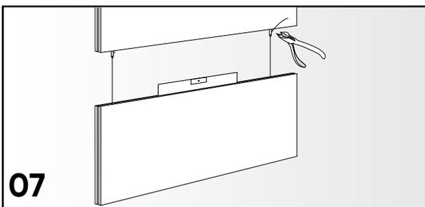
**07** Zweites Panel mit Wasserwaage ausrichten. Ggf. Seillänge nachjustieren. Metallseile kürzen.
