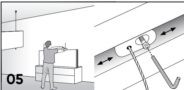
**05** Ggf. Positionsänderung der Anbindungsbeschläge: Schrauben mit einem Innensechskantschlüssel Grösse 3 lockern, Beschlag verschieben, Schrauben wieder fest anziehen (siehe auch S. 3).
