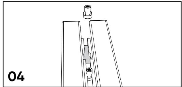
Die Laufschuhe lassen sich über die Rahmenöffnung herausnehmen und an einer anderen Paneelseite wieder einführen.
