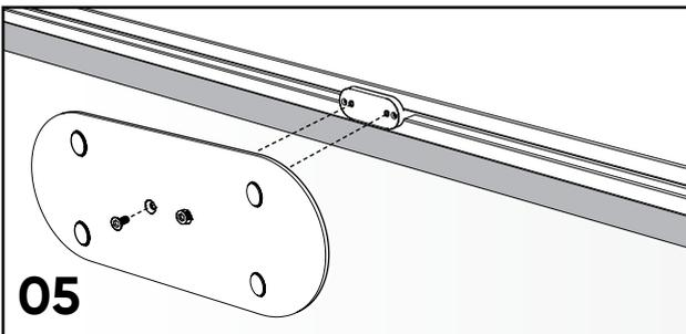
05 CENTERBASE Fussplatte locker mit Paneeladapter verschrauben. Dazu mitgelieferte Schrauben nacheinander handfest in die Gewindeöffnungen eindrehen.
