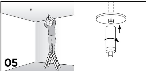
05 Deckenanbindungen montieren: Deckenscheibe auf herausstehendes Dübelgewinde stecken und mit Deckenzylinder verschrauben.
