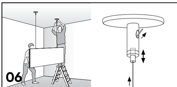
06 Metallseil von unten in den Anschlusszylinder einführen und durchführen. Durch Eindrücken der unteren Stiftöffnung lässt sich das Seil dearrätieren und fein justieren.
