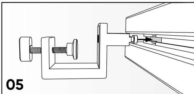
Neue Anbindungslosung inklusive Laufschuhe in die Öffnung einführen und an die gewünschte Position schieben.
