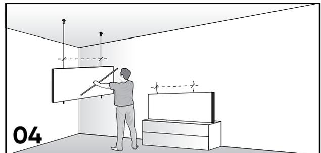
**04** Abstand zwischen den Seilen der schon montierten Paneelsituation messen und auf die darunter zu montierenden Situation übertragen.
