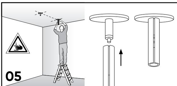
05 Deckenanbindungen mittels des Montagewerkzeuges an der Decke anbringen. Durch den verlängerten Hebel lassen sich die Deckenanbindungen problemlos wieder lösen und neu positionieren.
