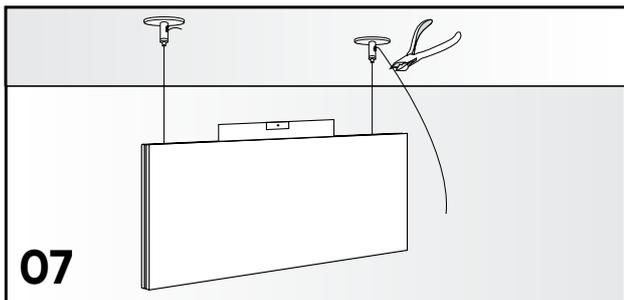
07 Panel mit Wasserwaage ausrichten. Ggf. Seillängen nachjustieren (Schritt 06). Metallseile kürzen.
