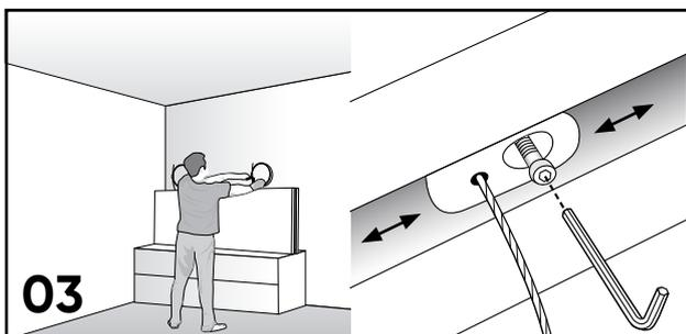
03 Ggf. Positionsänderung der Anbringungsbeschläge: Schrauben mit einem Innensechskantschlüssel Grösse 3 lockern, Beschläge verschieben, Schrauben wieder fest anziehen (s. auch S. 3)
