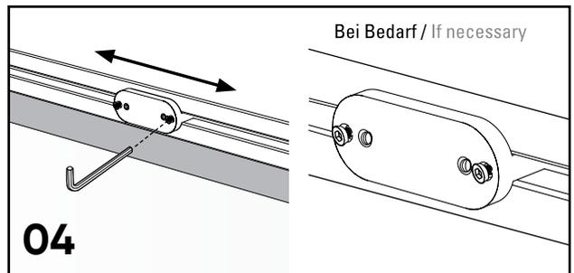
04 Ggf. Positionsänderung des Paneeladapters: Schrauben mit einem Innensechskantschlüssel Grösse 3 lockern, Paneeladapter verschieben, Schrauben wieder fest anziehen (s. auch S. 3).
