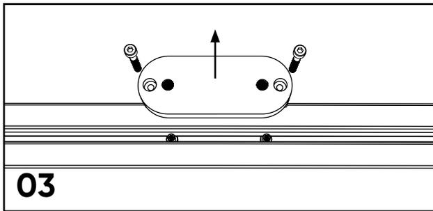
Paneeladapter bzw. Anbindungsbeschläge inklusive Schrauben abnehmen und für die weitere Verwendung beiseitelegen.
