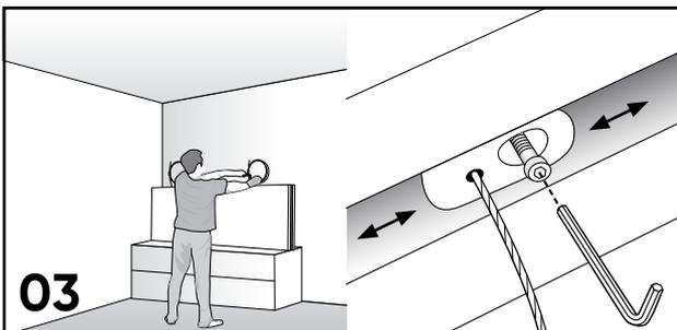
03 Ggf. Positionsänderung der Anbindungsbeschläge: Schrauben mit einem Innensechskantschlüssel Größe 3 lockern, Beschläge verschieben, Schrauben wieder fest anziehen (s. auch S. 3)
