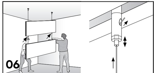
**06** Zweites Panel mit den Seilen von unten in die Anschlusszylinder einführen und durchführen. Durch Eindrücken der unteren Stiftöffnung lässt sich das Seil dearrätieren.
