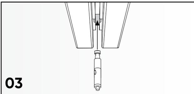
**03** Beide Anschlusszylinder mit den vormontierten Laufschuhen in die Rahmen-Öffnung des schon hängenden Panels einführen.
