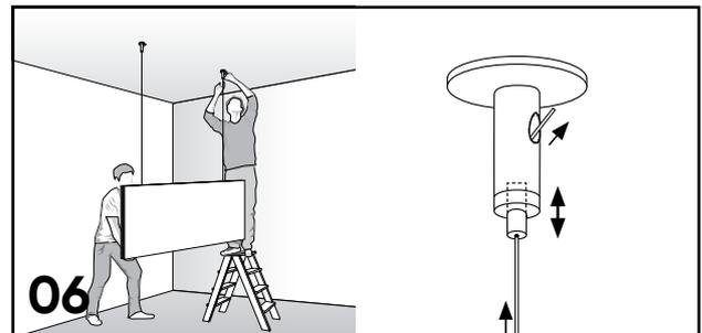
06 Metallseil von unten in den Deckenzylinder einführen und durchführen. Durch Eindrücken der unteren Stiftöffnung lässt sich das Seil dearrätieren und ggf. fein justieren.
