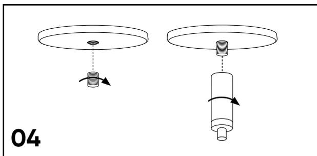
04 Deckenanbindungen montieren: Gewindestifte in Deckenmagnete eindrehen. Danach Deckenzylinder mit Magneten verschrauben.
