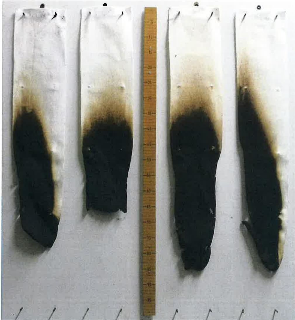
Abb. 6: Aussehen der 4 Proben nach Brandschachtversuch B
