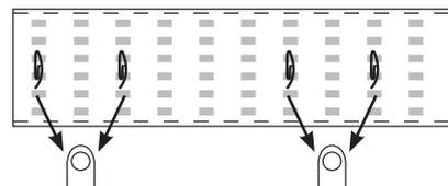
Nach dem Aufhängen der Aussenstoffe können die abschliessenden Seiten des NoiseBlockers oder des NoiseSilencers oben, mittig und unten mit den Klipps bestückt werden und final in das Klett-Flauschband glatt und bündig mit etwas Spannung geschlossen werden (5).
