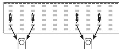
Après avoir monté les couches de tissu extérieures, les côtés finaux du NoiseBlocker ou du NoiseSilencer peuvent être fixés avec les clips en haut, au milieu et en bas et finalement fermés en douceur et de manière affleurante dans le rabat Velcro avec une légère tension (5).
