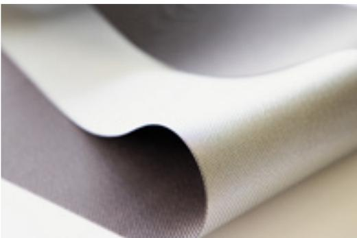
Blend- und Wärmeschutz-Metallisierung
